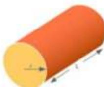
“Nace de la Multiplicación del Volumen y la Densidad del Elemento a Izar”
